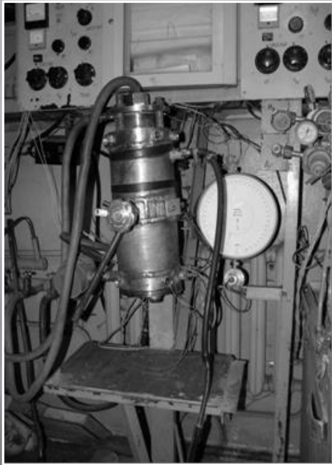
Експериментальна установка отримання газарів
