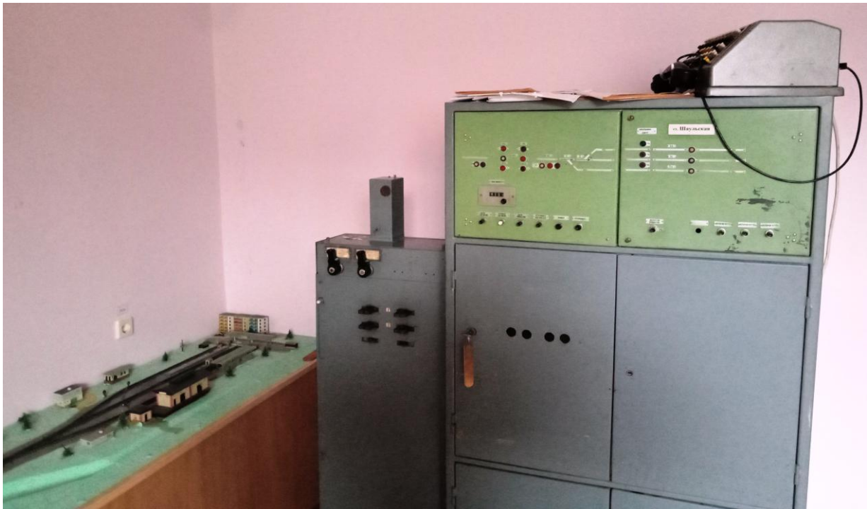
Макет залізниці в лабораторії «Організація руху поїздів», робоче місце чергового по станції, обладнаної ключовою залежністю стрілок та сигналів, аудиторія № 4413
